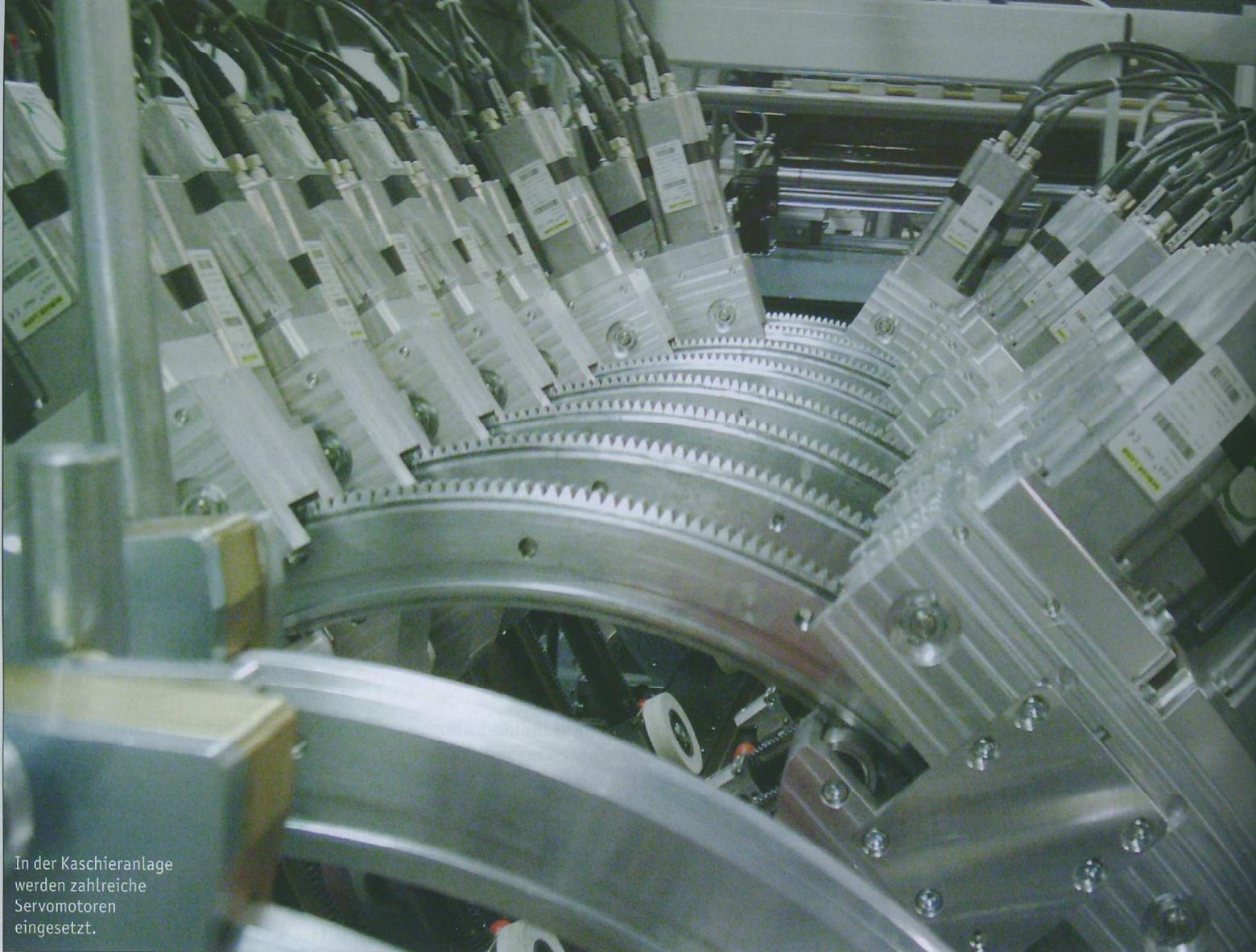
In der Kaschieranlage werden zahlreiche Servomotoren eingesetzt.
