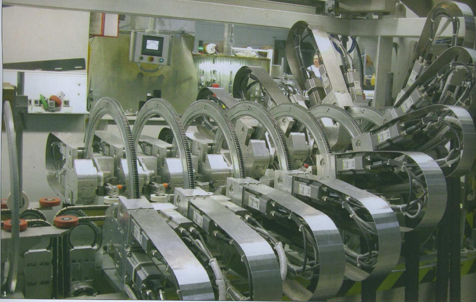
reich getrocknet. Danach erfolgt der Auftrag des Heißklebers und es beginnt der eigentliche Kaschiervorgang mit dem Aufbringen und Anformen der Folien auf das zu veredelnde Profil. Nach dem Kaschieren wird im Trimbereich (optional) die überstehende Folie beschnitten und im Auslaufbereich wird eine Schutzfolie auf das kaschierte Profil aufgebracht.
